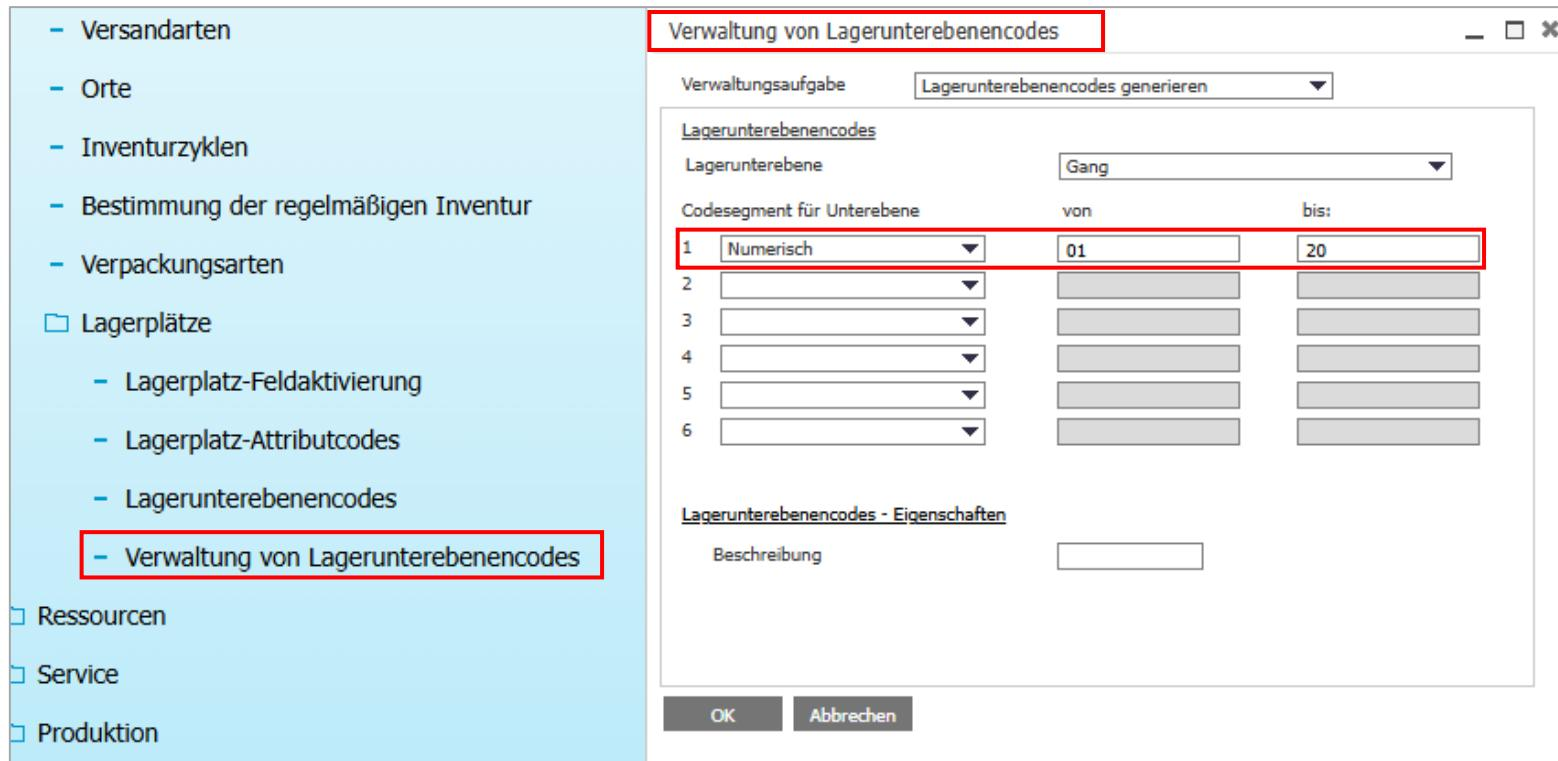
**Lagerunterebene:** Wählen Sie aus einer Auswahlliste mit aktiven Lagerunterebenen eine Unterebene, für die Sie die Codes definieren möchten (Standardmäßig ist Lagerunterebene 1 aktiviert).
